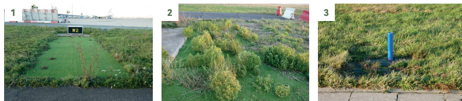
1. et 2. Revêtement de gazon synthétique avec ou sans sous-couche de géotextile. 3. Essai non concluant de pose d'un grillage en pied de balise. Aéroport d'Orly
