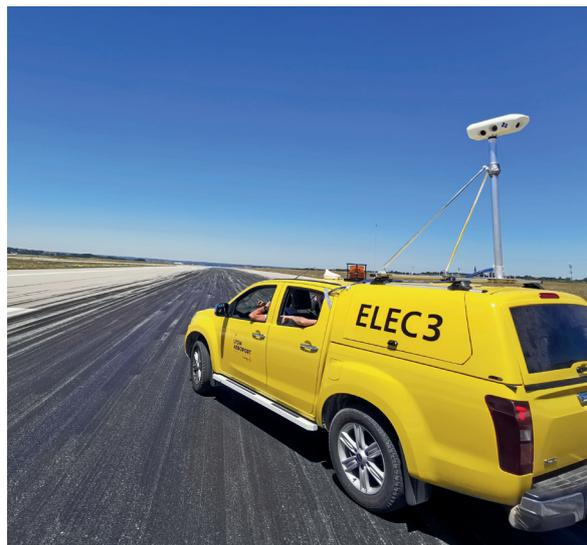
C'est pour accroître encore la sécurité côté piste et la porter au plus haut niveau d'exigence, que Flyinstinct a développé le FODlocator : un assistant mobile intelligent qui accompagne l'inspecteur dans la détection des FOD, et fonctionnant sous n'importe quelles conditions météorologiques.
